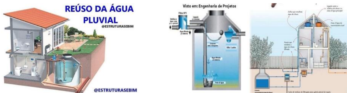
Figura 3 - Imagem ilustrativa da forma como a água é captada e reutilizada
