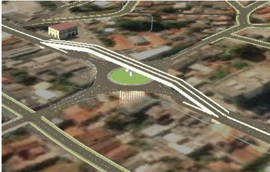
Figura 06: Projeto do viaduto executado no Infracworks
